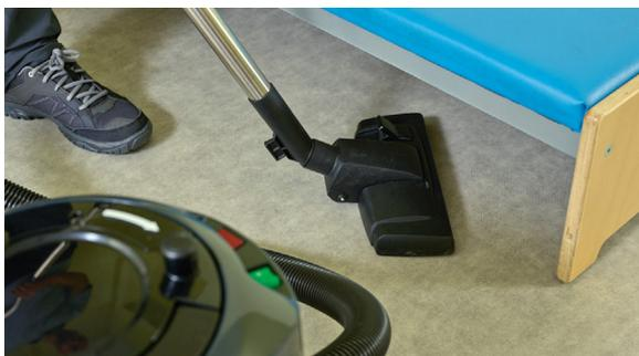
После удаления пыли и мусора, с помощью спрея нанесите раствор чистящего средства с нейтральным рН на очищаемую секцию (или, в зависимости от уровня загрязнения - легкое щелочное чистящее средство), тщательно разбавленный в соответствии с инструкциями производителя. Оставьте на время, необходимое для реакции и удаления загрязнений. Может потребоваться немного взболтать мягкой щеткой.
